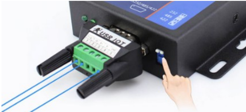
Ilustración 4: Posición del switch para funcionar con RS-485
